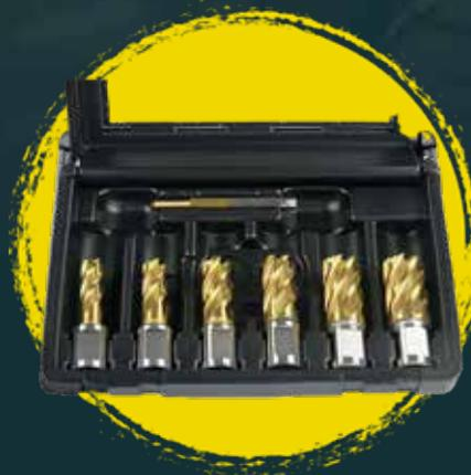
**Art. 490145TiN** - Ø 12, 14, 16, 18, 20, 22 mm + perno di espulsione. Profondità di taglio: 30 mm. Portautensile Weldon 19 mm, elevata resistenza all'abrasione e bassa reattività, lunghissima durata.
